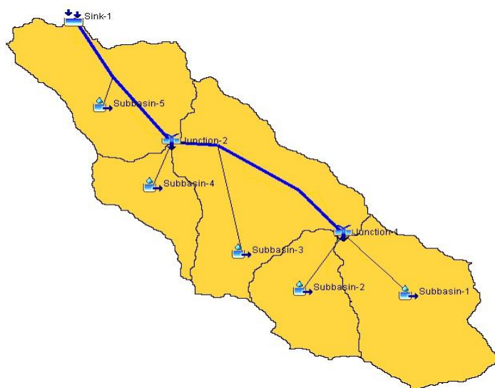
شکل ۲. مدل حوضه تهیه شده از حوزه آبخیز گردو برای قبل و بعد از اجرای عملیات بیولوژیک.
