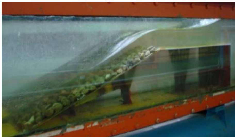
شکل ۲. مدل آزمایشگاهی تنداب با بستر زبر Figure 2. Experimental physical model of chute with rough bed
