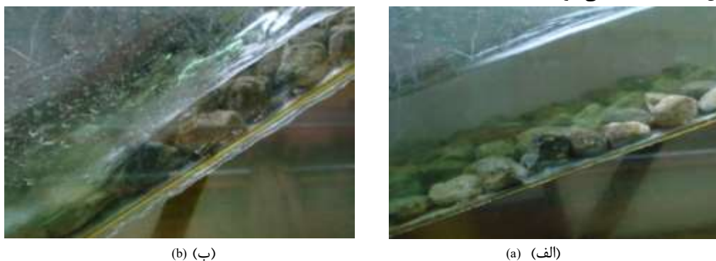
شکل ۶. پروفیل سطح آب برای تنداب با سطح کاملاً زبر (الف) شیب ۲۸/۷ درجه (ب) شیب ۲۰/۶ درجه
